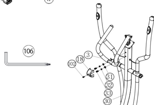
**SCHRITT 7:****Montage des Computers (1) am Stützrohr (30).**
