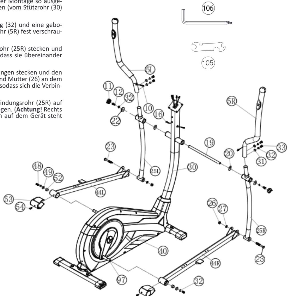
**SCHRITT 5:****Montage der Fußschalen (43) an den Fußhebeln (44).**
