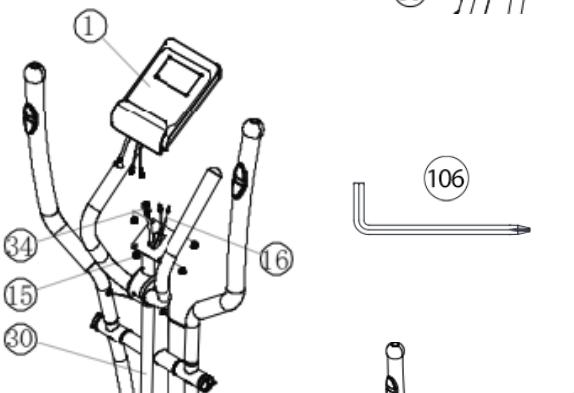
**ÉTAPE N° 8:****Branchements de l'appareil d'alimentation électrique (13).**
