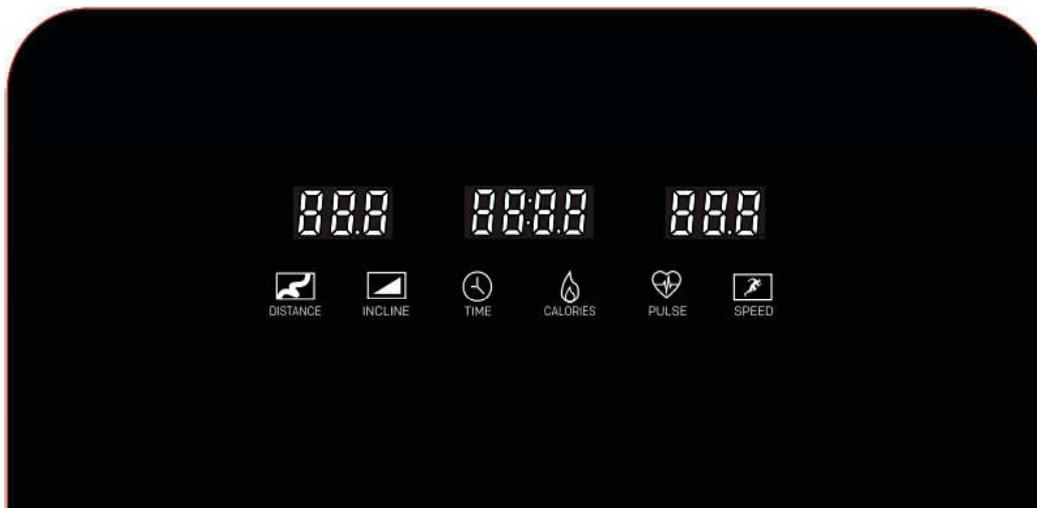
Die Anzeige des Displays informiert Sie in drei LCD-Fenstern über folgende Trainingswerte, wobei immer zwei werte im Wechsel pro Fenster angezeigt werden:
