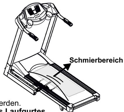
Der Laufgurt sollte auf der Unterseite von rechts und links geschmiert werden.
