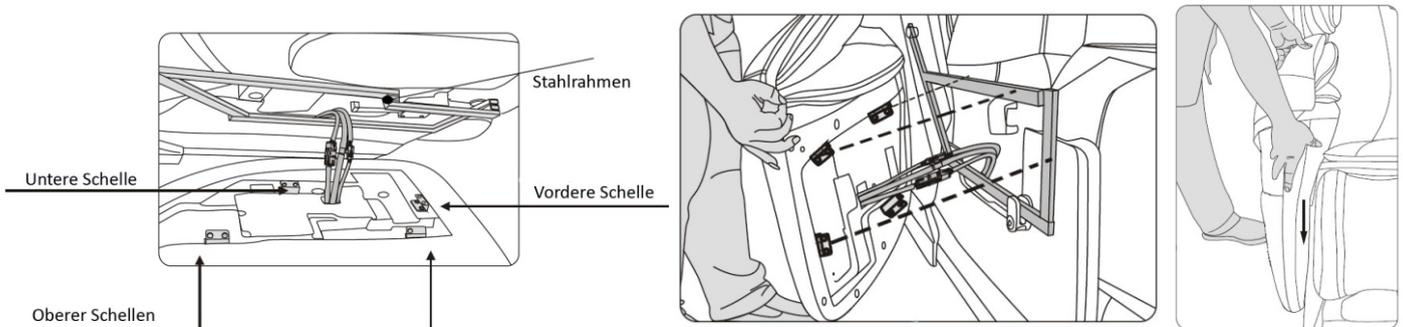
3) Die Armlehne wird mit nur zwei Schrauben in dieser Position fixiert. Die erste Inbusschraube wird hinten zwischen Sitzpolster und Rückenlehne eingeführt und festgezogen. Die zweite Schraube wird vorne, zwischen Sitzpolster und Bein-Einheit, eingeführt und festgezogen.
