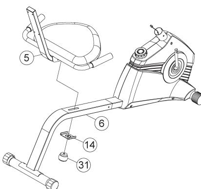
**Etape n° 4 :****Installation de la repose dos (32) sur la cadre de siège (5).**
