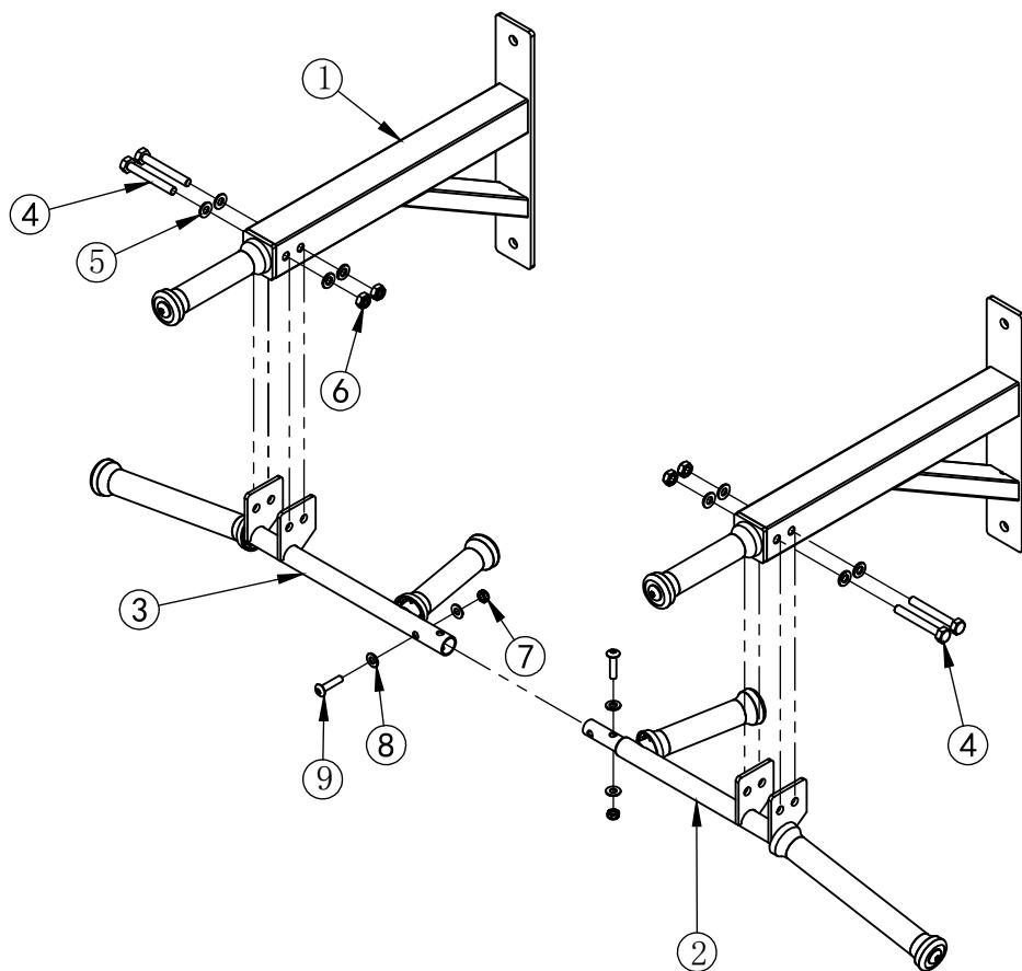
Las clavijas de alta resistencia incluidas en el volumen de suministro sólo son adecuadas para paredes de hormigón. En caso de duda, solicite asesoramiento técnico o pida a su distribuidor especializado que le aconseje si los tacos incluidos en el volumen de suministro son adecuados para sus paredes.
