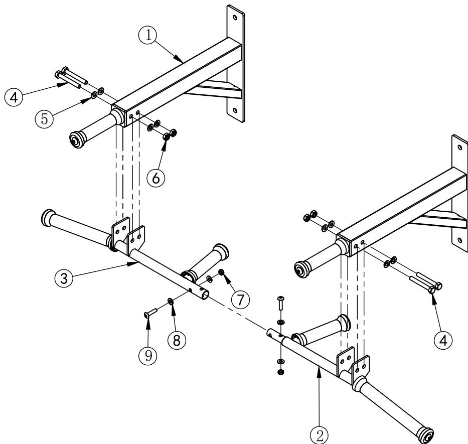
Die im Lieferumfang enthaltenen Schwerlastdübel sind **ausschließlich** für Betonwände geeignet. Bitte holen Sie sich im Zweifelsfall fachlichen Rat ein bzw. lassen Sie sich im Fachhandel beraten, ob die im Lieferumfang enthaltenen Dübel für Ihre Wände geeignet sind.
